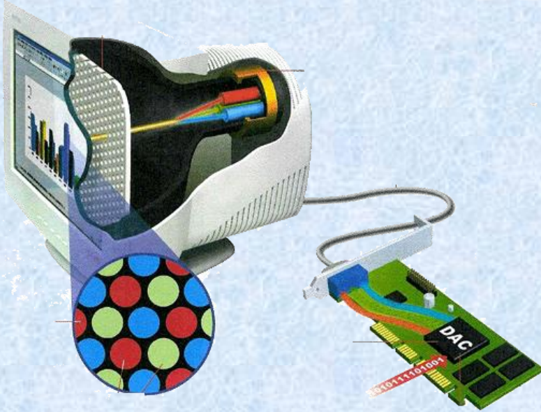
Katódsugárcsöves (CRT) monitor működése
